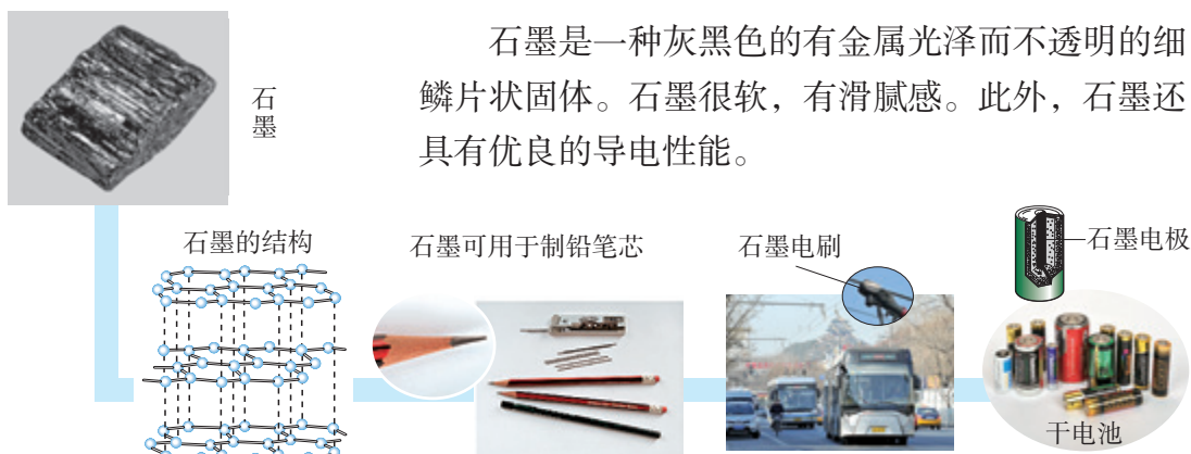
图6-2 石墨的结构及用途
