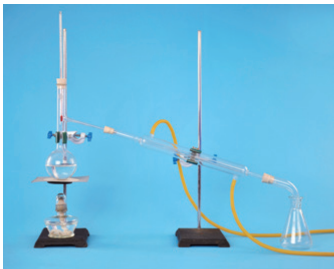
图4-20 实验室常用的蒸馏装置
