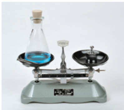
图5-3 铁钉与硫酸铜溶液反应前后质量的测定
