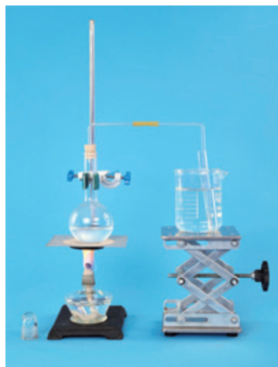
图4-21 制取蒸馏水的简易装置
