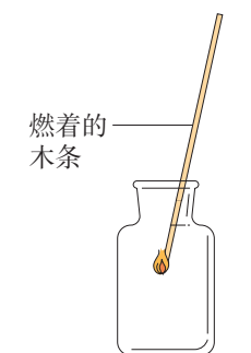
图1-17 用燃着的小木条检验气体
