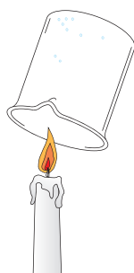
图1-11 在蜡烛的火焰上方罩个内壁沾有澄清石灰水的烧杯
