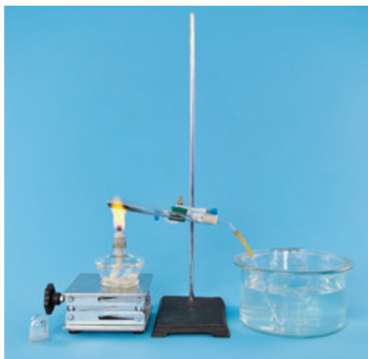
图2-14 加热高锰酸钾制取氧气
