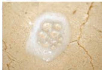
图 11-3 盐酸腐蚀含碳酸钙的建材
