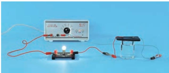
图 10-9 试验物质的导电性
