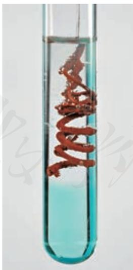
图8-13 铝与硫酸铜溶液的反应
