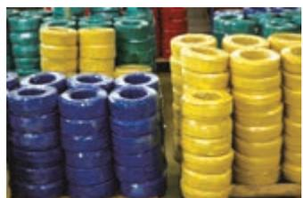
电线外面的绝缘层是聚氯乙烯塑料
