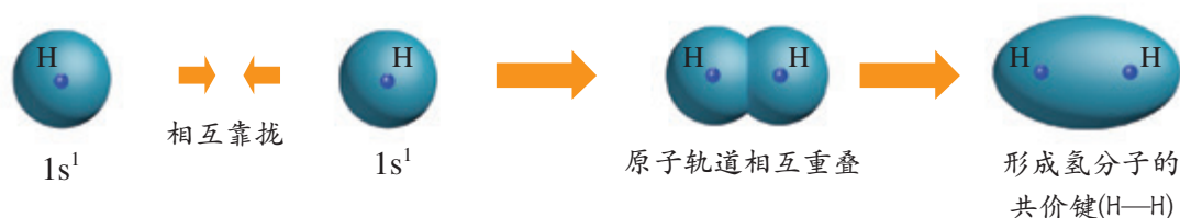
图2-1 氢原子形成氢分子的过程示意
