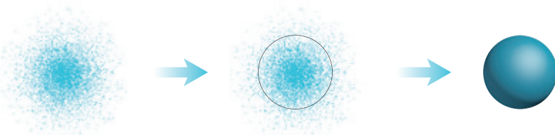
图1-8 电子云轮廓图的绘制过程
