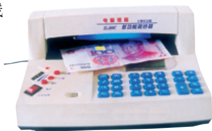
图4.5-7 紫外线使钞票上的荧光物质发光
