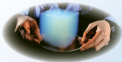
图6.4-5 气凝胶是当今世界上密度最小的固体。这种新材料具有隔热、耐高温等性能，有多种用途。
