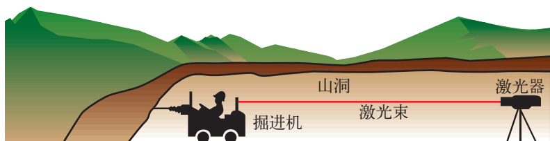
图4.1-4 激光引导掘进方向
