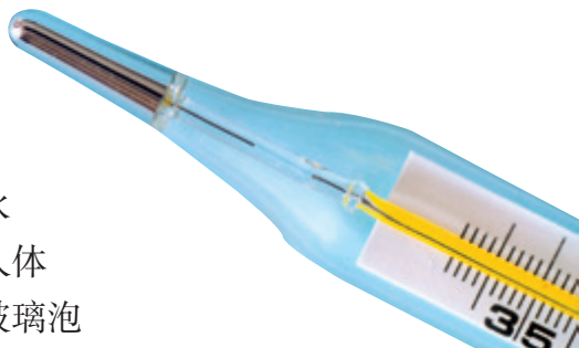
图3.1-4 体温计 （细管处水银柱断开）
