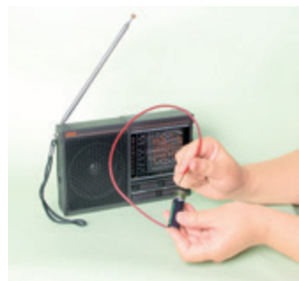
图21.2-2 时断时续的电流能够产生电磁波
