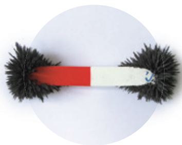
图20.1-3 条形磁体两端的磁性最强
