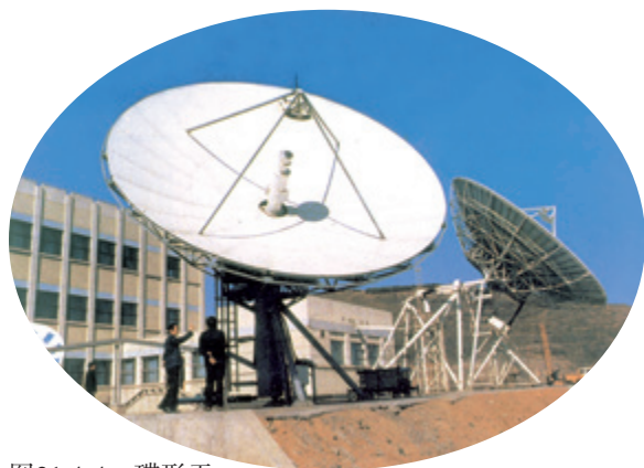
图21.4-4 碟形天线用来接收来自卫星的信号
