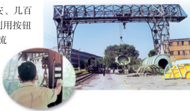
图20.3-4 工人师傅手中的按钮只是继电器的开关
