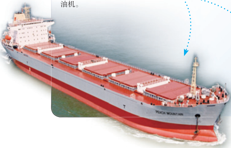
图 14.2-4 摩托车使用汽油机，挖土机使用柴油机，货船使用大型柴油机。
