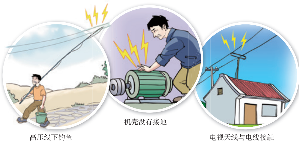
图 19.3-4 几种容易引起触电的情况
