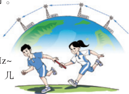
图21.4-1 微波中继通信示意图
