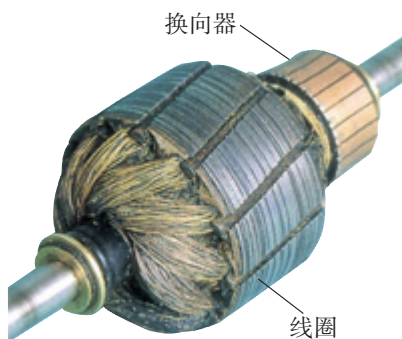
图 20.4-7 实际的直流电动机的转子
