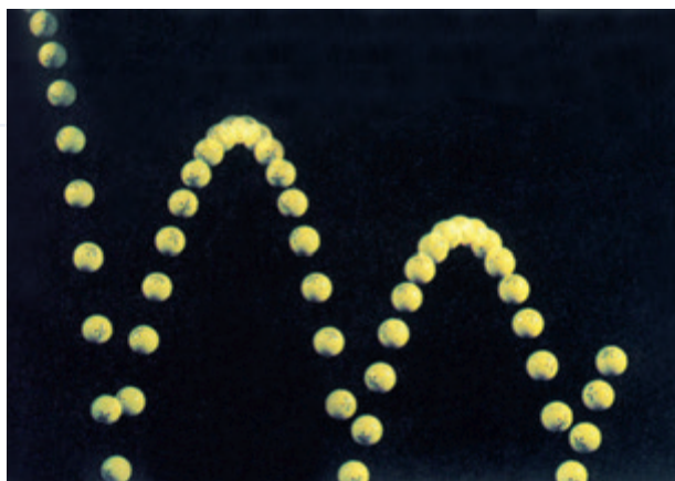
图14.3-2 小球在地面弹跳的频闪照片
