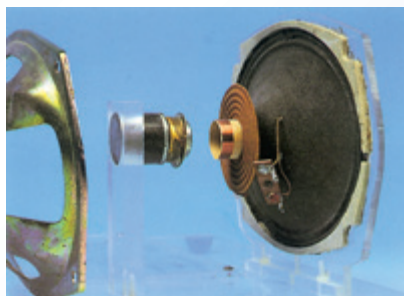
图 20.4-8 扬声器的结构
