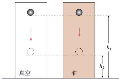
图8.4-2 小球在真空和油中的下落
