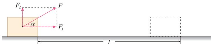
图8.1-1 物体在力 $F$ 的作用下发生位移 $l$
