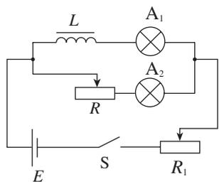
图 2.4-1 开关闭合时观察灯泡的发光情况
