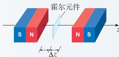
图 5.2-13 利用霍尔元件测量微小位移
