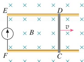
图 2.1-7 判定感应电流的方向
