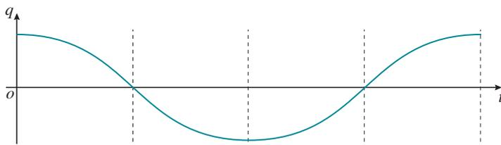
图4.1-2  $LC$ 振荡电路及电流、电荷量的变化
