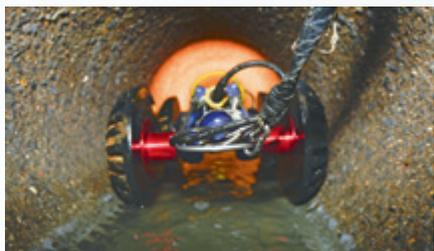
甲 机器人在下水道里探测水下管网
