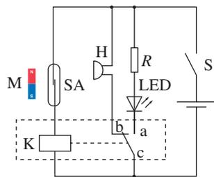
图 5.3-2 门窗防盗报警装置电路图
