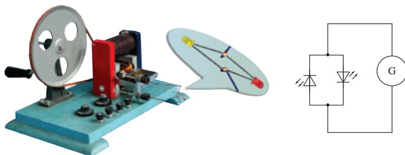
图3.1-2 教学用发电机能够产生交变电流
