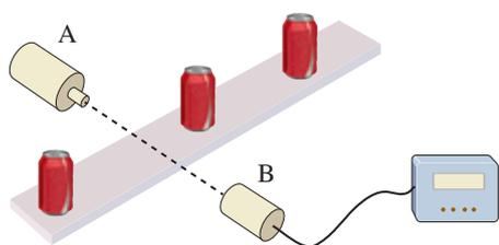
图 5.2-3 光电计数的基本原理
