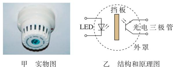
图5-4 烟雾散射式火灾报警器
