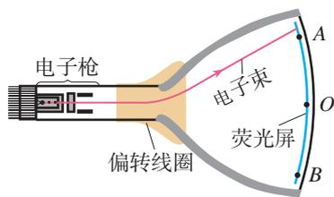
图1.2-7 显像管原理示意图(俯视图)
