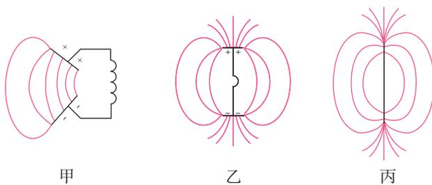
图4.3-1 由闭合电路变成开放电路
