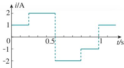
图 3.2-2 某种交变电流的波形
