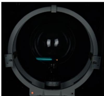
图 1.3-3 没有磁场时电子束沿直线运动
