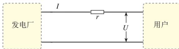
图 3.4-2 输电电路图
