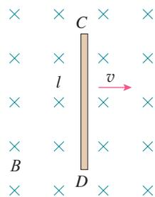
图2.2-4 导体棒做切割磁感线运动
