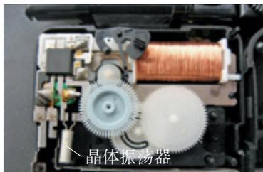
图4.1-4 石英电子钟里的晶体振荡器
