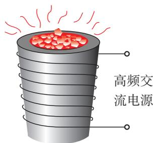
图 2.3-3 真空冶炼炉
