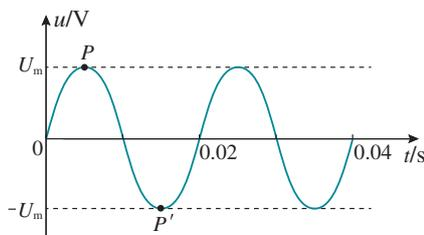
图3.2-1 交变电流的  $u-t$  图像
