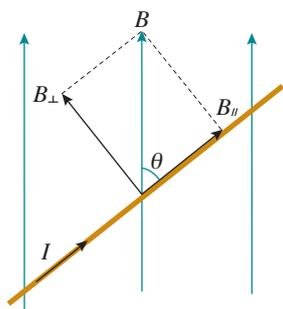
图 1.1-4  $B$  与电流方向的关系
