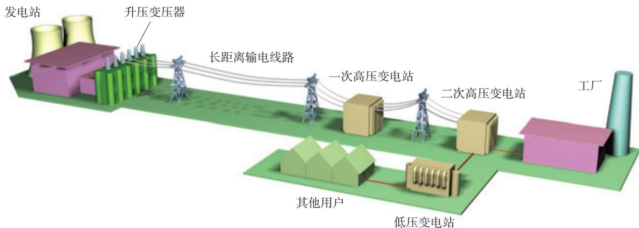
图 3.4-3 输电过程示意图
