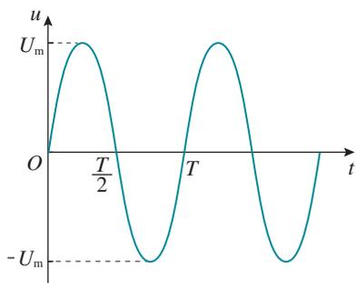
图 3.2-3 正弦式交变电流  $u-t$  图像
