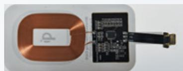
图3.3-5 无线充电接收器中的线圈
