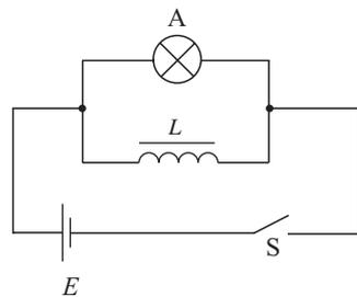
图 2.4-3 开关断开时观察灯泡的亮度
