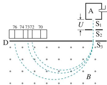
图1.4-1 质谱仪工作原理
