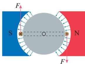
图 1.1-8 极靴和铁质圆柱使磁场沿半径方向
