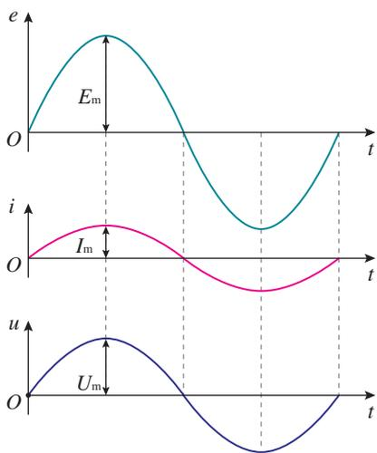
图 3.1-6 正弦式交变电流随时间的变化
