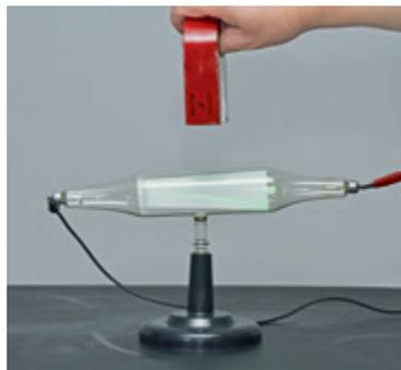
图1.2-1 电子束在磁场中受力偏转
