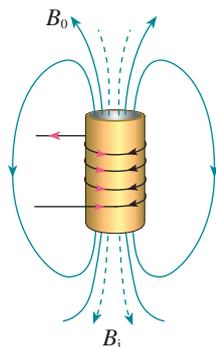
图 2.4-2 感应电动势阻碍电流的增加
